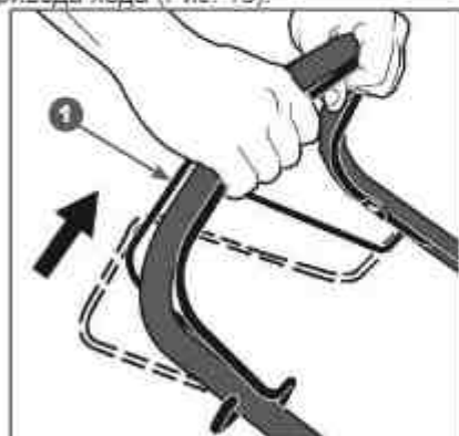
Рис. 18 Включение привода хода
