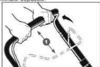
Рис. 14 Рычаг остановки двигателя
