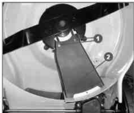
Рис. 28 Кожух защитный ремня привода 1. Винт 2. Кожух
