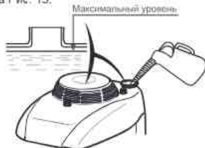
Рис. 13 Максимальный уровень топлива в топливном баке
