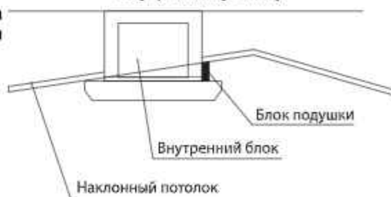
Рисунок 17 - Установка внутреннего блока на наклонном потолке
