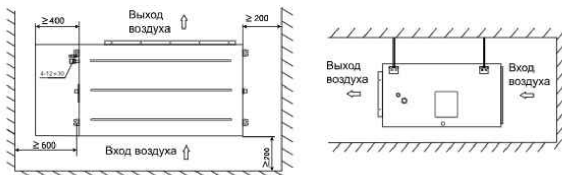
Рисунок 29 - Необходимое пространство для установки внутренних блоков канального типа
