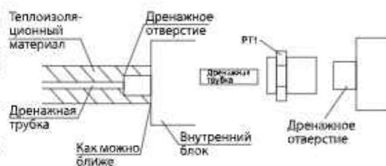
Рисунок 19 - Подсоединение дренажной трубки к внутреннему блоку
