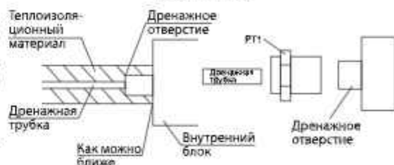
Рисунок 26 - Подсоединение дренажной трубки к внутреннему блоку
