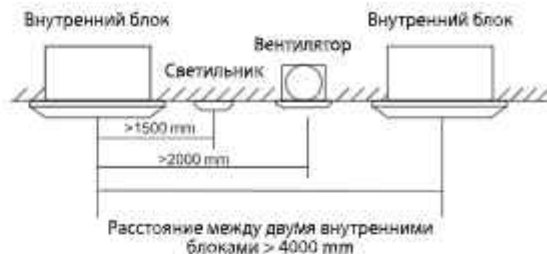
Рисунок 14 - Необходимое пространство для установки внутренних блоков кассетного типа
