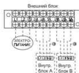
Рисунок 50 - Схема межблочных соединений сплит-системы с несколькими внутренними блоками
