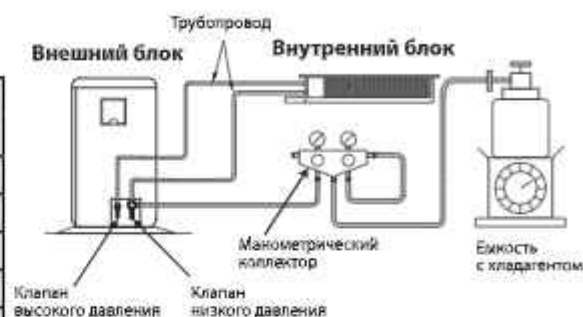
Рисунок 48 - Схема дополнительной заправки хладагентом
