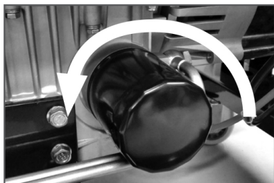
Рис. 15 Замена масляного фильтра
