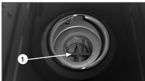
Рис. 9 Максимальный уровень топлива
