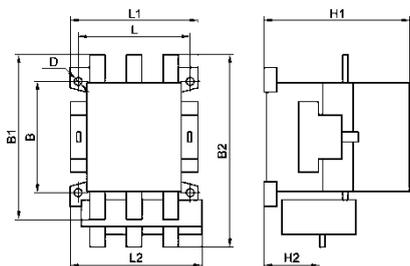
Рисунок 1. Пускатель нереверсивный ПМ12 100-250А. Степень защиты - IP00
