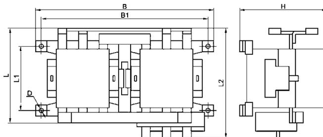
Рисунок 2. Пускатель реверсивный ПМ12 100-250А. Степень защиты - IP00
