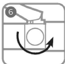
6 Поверните винт сброса давления в положение «Открыть».
