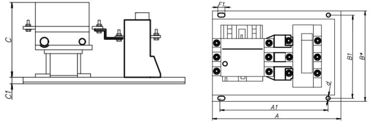
Рисунок 9. Контактры с тепловым реле ПМЛ-5200, ПМЛ-6200, ПМЛ-7200
