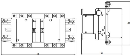
Рисунок 8. Контактры реверсивного исполнения ПМЛ-5500, ПМЛ-6500, ПМЛ-7500, ПМЛ-8500, ПМЛ-9500 (125-630А)
