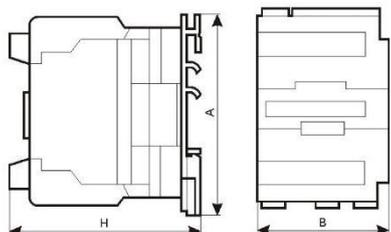
Рисунок 1. Контактор нереверсивный ПМЛ-5160М
