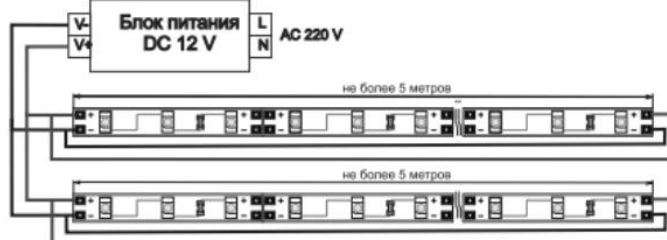
Параллельное подключение лент с двух сторон к одному блоку питания
