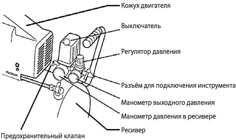
Электрический двигатель приводит в движение коленвал ЦПГ, при движении поршня вниз, через воздушный фильтр происходит всасывание воздуха через систему клапанов в цилиндр. При движении поршня вверх, воздух сжимается и подается в ресивер для накопления. По мере наполнения ресивера сжатым воздухом, давление в ресивере растет. При достижении максимально допустимого давления, автоматика отключит двигатель компрессора.
