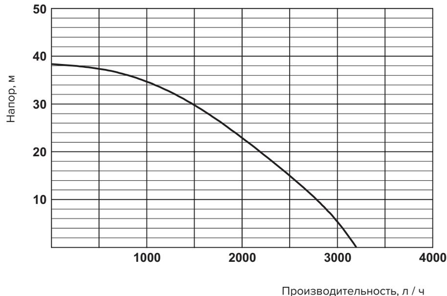
Рисунок 1 — График зависимости производительности насоса от напора
