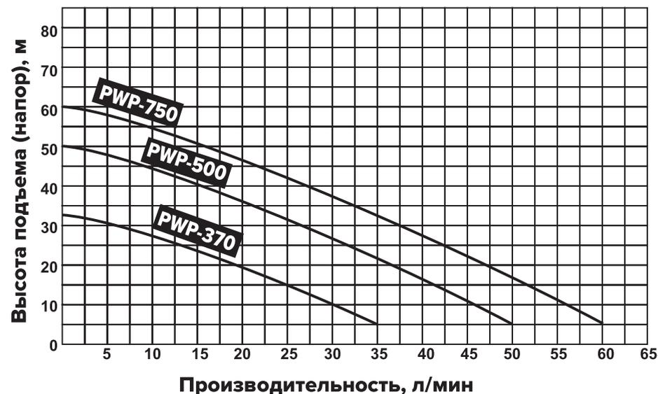
Рисунок 1 — График зависимости производительности насоса от высоты подъема воды
