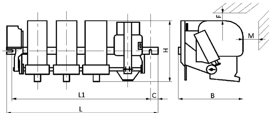
Рисунок 1. Габаритные и установочные размеры КТ-66х
