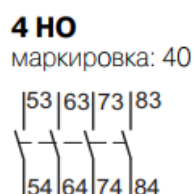
Рис. 3 Принципиальные электрические схемы фронтальных блок-контактов 3RH1911-_F_ для S00
