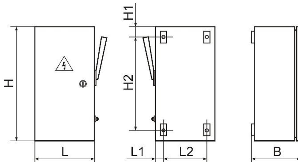
Рисунок 3. Общий вид и габаритные размеры ящиков силовых
