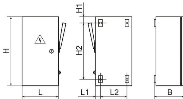
Рисунок 1. Общий вид и габаритные размеры ящиков силовых
