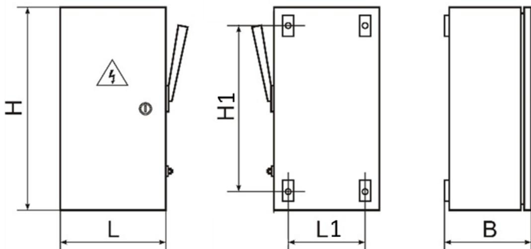
Рисунок 2. Габаритные и установочные размеры ящиков силовых ЯБПВУ-М
