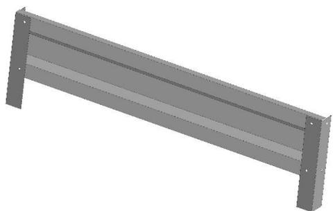
С помощью винтов и гаек прикрутите к каждой боковой стенке по 2 ножки, как показано на рисунке. Ножки крепятся с внешней стороны стенки.
