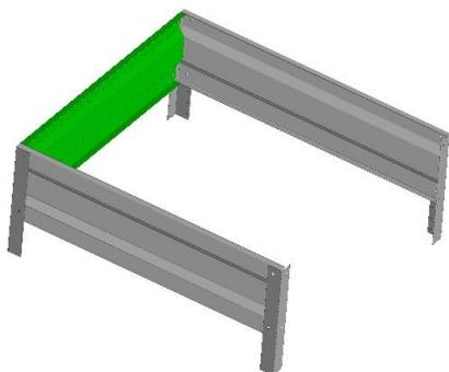
С помощью винтов и гаек прикрутите торцевую стенку. Стенка крепится с внутренней стороны
