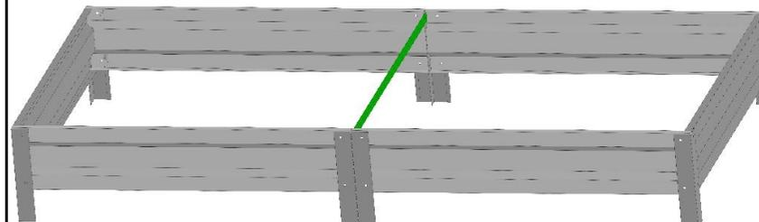
С помощью винтов и гаек прикрутите усиливающую стяжку
