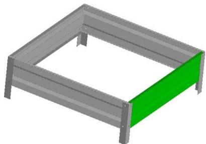
С помощью винтов и гаек прикрутите вторую торцевую стенку. Стенка крепится с внутренней стороны
