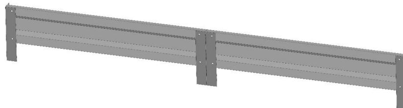
Соедините боковые стенки между собой при помощи винтов и гаек через двойную ножку(два комплекта)
