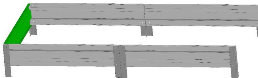
С помощью винтов и гаек прикрутите торцевую стенку. Стенка крепится с внутренней стороны
