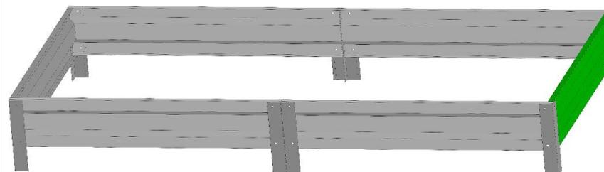
С помощью винтов и гаек прикрутите вторую торцевую стенку. Стенка крепится с внутренней стороны
