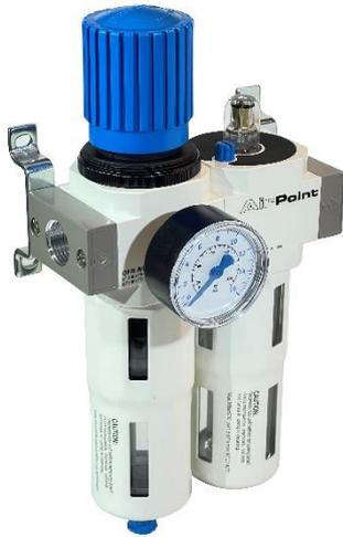
Блок подготовки сжатого воздуха предназначен для удаления капельной влаги, фильтрации, снижения давления пневмосистемы до заданного уровня, поддержания давления на выходе и автоматической подачи смазки к различным пневматическими инструментами.
