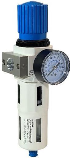
Редуктор-фильтр предназначен для снижения давления сжатого воздуха, сепарирования капельной влаги и фильтрации сжатого воздуха от масла и твёрдых загрязняющих веществ.
