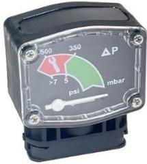
Индикатор загрязнения представляет собой дифференциальный манометр и предназначен для контроля загрязнения фильтров CJ AirPoint. Устанавливается в верхнюю часть колбы фильтра и предназначен для визуальной индикации загрязнения фильтрующего элемента для сжатого воздуха серии FJ компании AirPoint.
