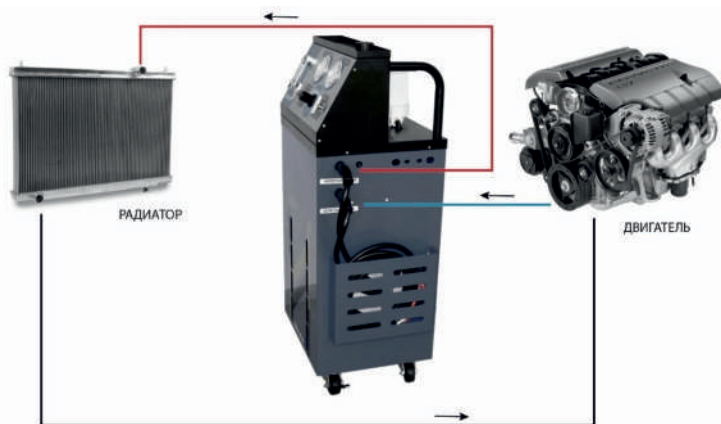
Рис. 3 Схема подключения изделия к системе охлаждения автомобиля
