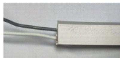
Для локального подключения рекомендуется использовать многожильный гибкий провод сечением от 0,14 до 0,5 кв.мм (AWG 26 – AWG 20) длиной до 15 см, до основной шины питания.
