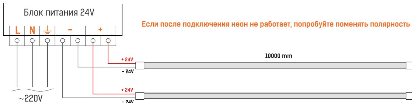
**ПРИМЕЧАНИЕ:** Обратитесь к схеме подключения для установки. Неправильное подключение может привести к короткому замыканию и выходу из строя изделия.
