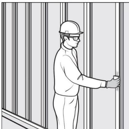
Перед нанесением герметика **KLEYKO GP-A**, необходимо произвести обработку поверхности герметизируемого шва.
