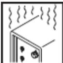
Чрезмерное использование может приводить к перегреву устройства. Использовать оборудование следует только в течение его рабочего цикла. Перед тем как снова начать сварку, необходимо снизить напряжение или сокращать следующий рабочий цикл. Перед следующим использованием прибор должен остыть. Подача воздуха на прибор не должна блокироваться.
