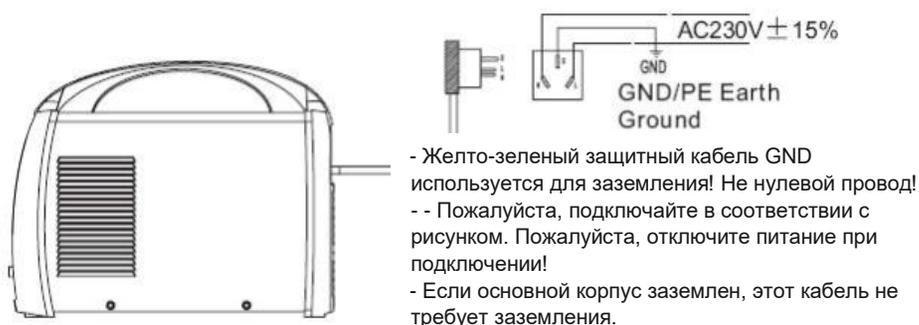
Рисунок 4-8-1: Соединение между входным кабелем питания и распределительной коробкой
