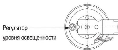
Рисунок 7. Регулятор уровня освещенности фотореле.
