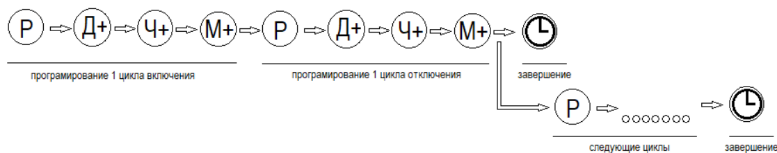
Рисунок 5. Алгоритм программирования циклов вкл/откл.
