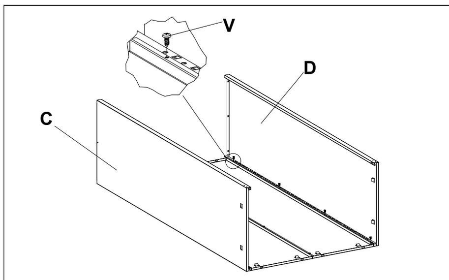
Установить стенки боковые **C**, **D** при помощи саморезов **V** (5,5x16).
