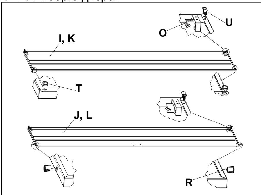
Установить петли пластиковые **O** на двери при помощи саморезов **U** (4,2x9,5). На дверь левую **I, K** установить упоры резиновые двусторонние **T**, а на двери правые **J, L** - фиксаторы направляющей **R**.
