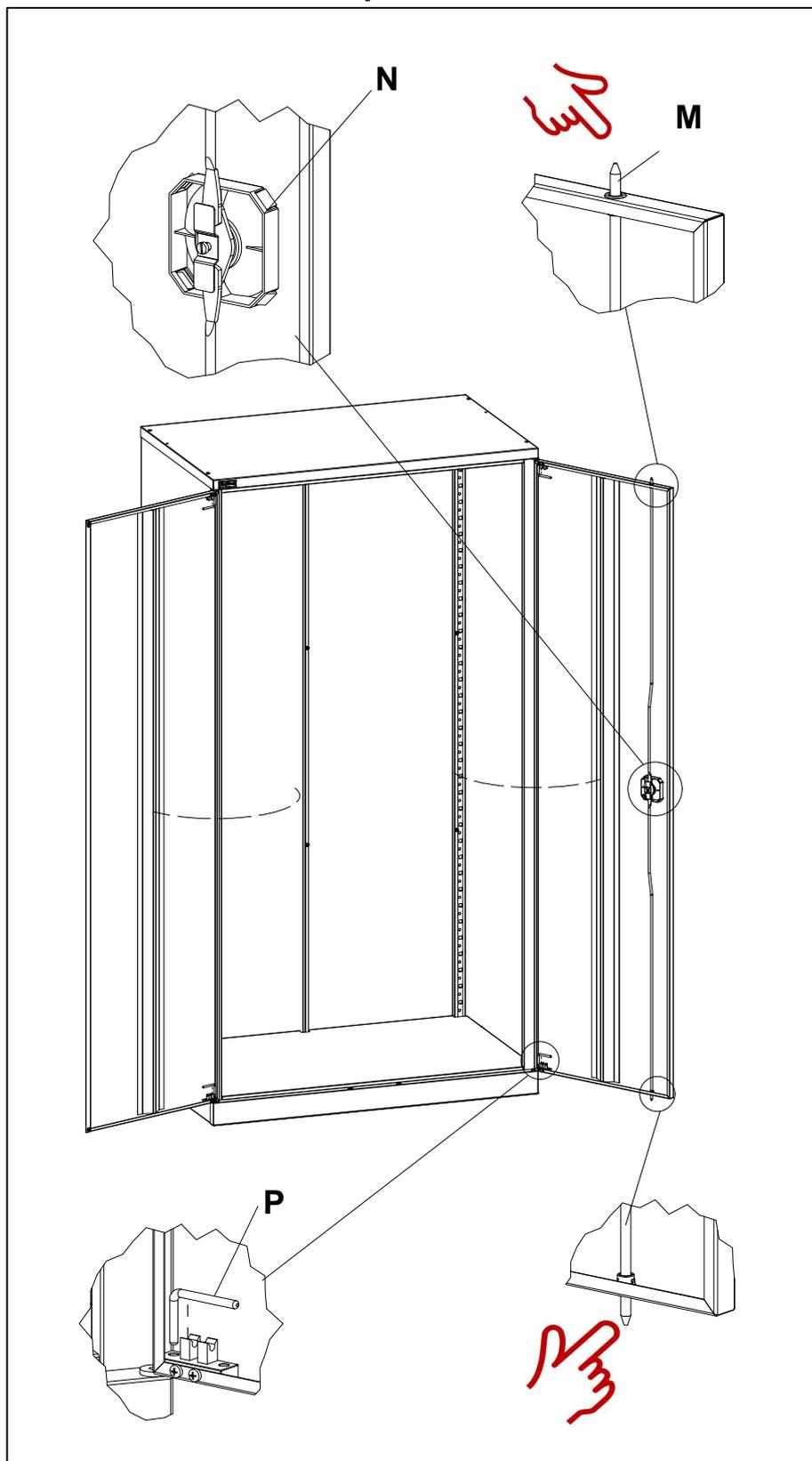
Установить замок **N** и тяги **M** на дверь, зафиксировав тяги на замке в положении "закрыто".
