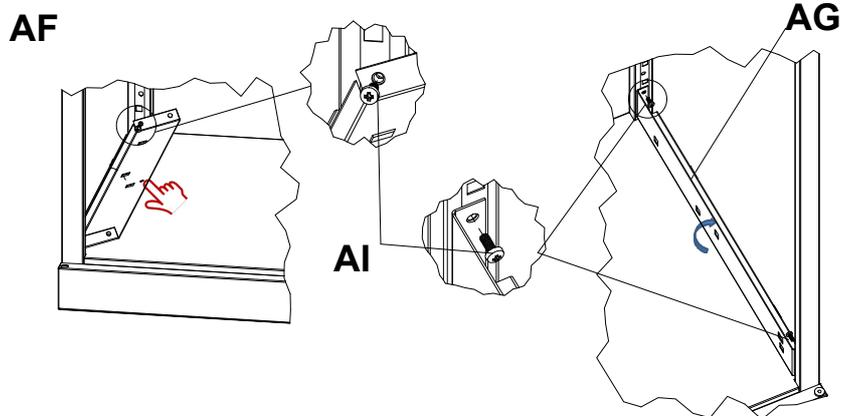
2) Установить кронштейн левый **AF** (отмечен □) и правый **AG**, зафиксировав их винтами **AI** (M5x12).
