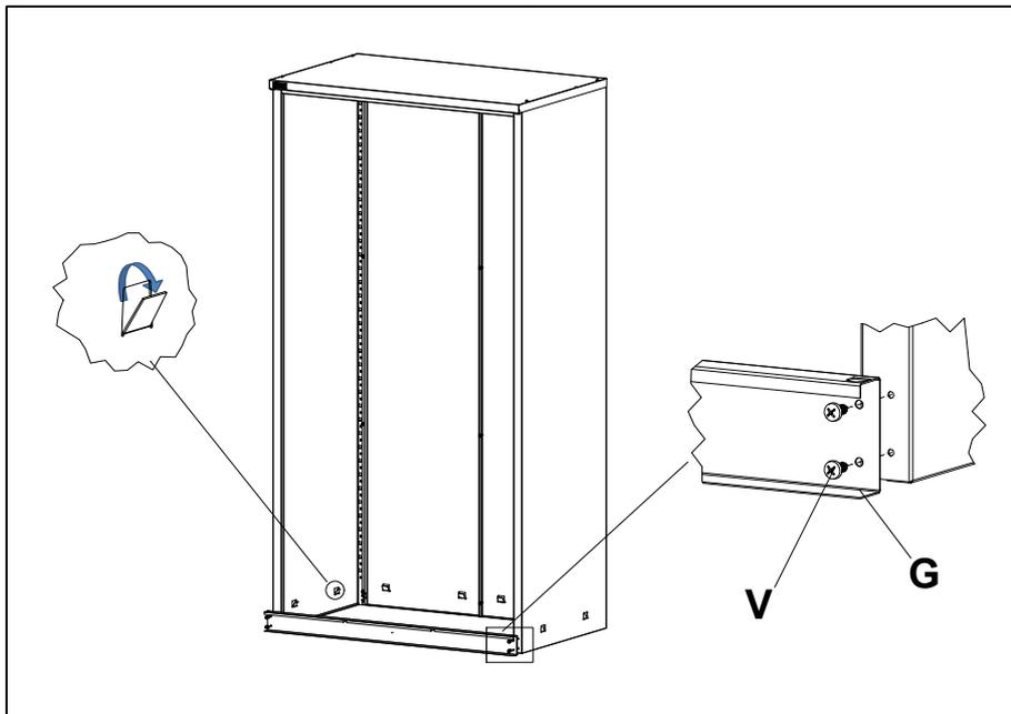
Установить панель крепёжную **G** при помощи саморезов **V** (5,5x16). Отогнуть внутрь зацепы на боковых и задних стенках.
