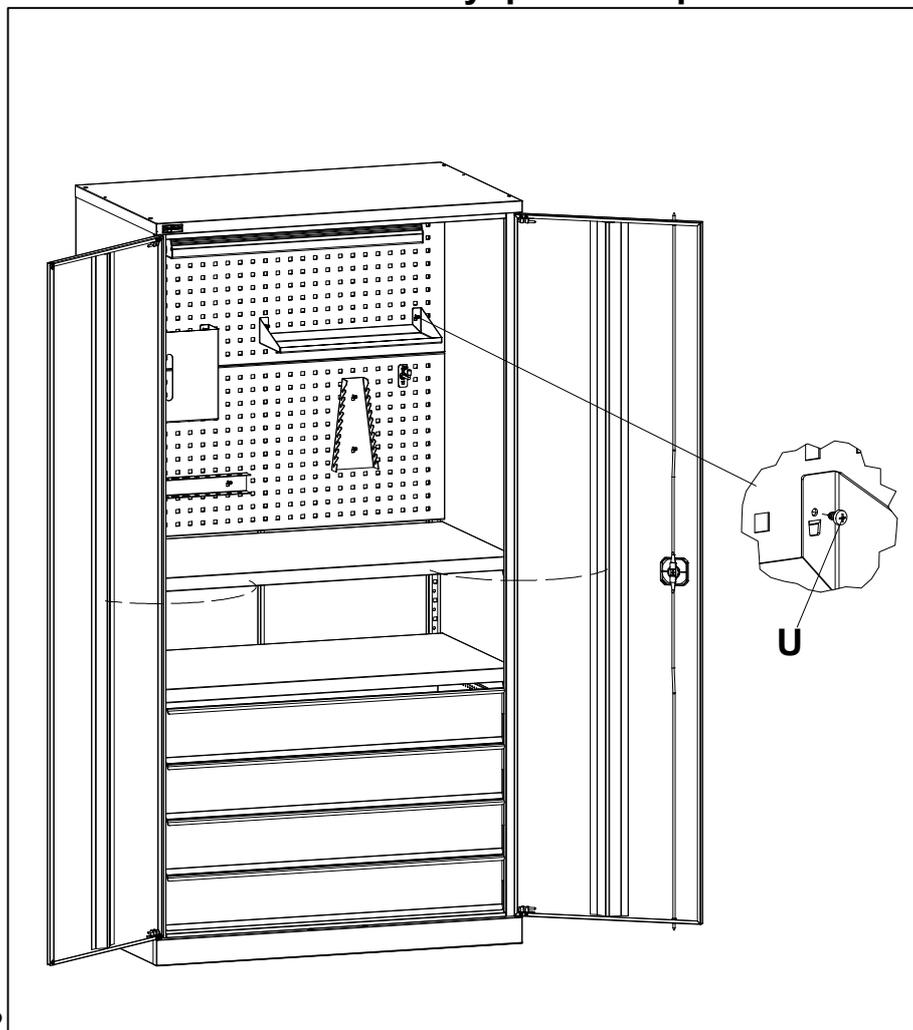
Аксессуары на экран устанавливаются на экран при помощи зацепов. Завести зацепы в отверстия экрана, затем установить стопорные саморезы **U** (4,2x9,5).
