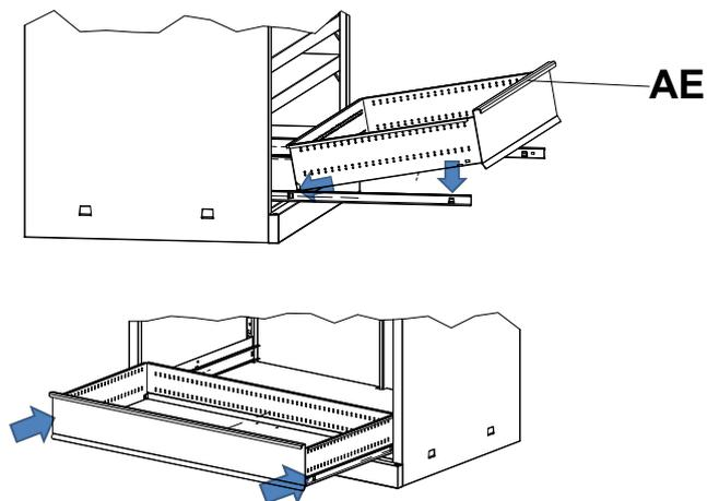
4) Завести ответные отверстия ящика **AE** в зацепы направляющих, установив его в корпус шкафа.
