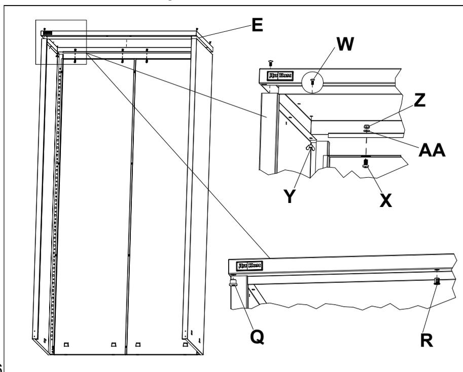
Установить крышку **E** при помощи винтов **W** (M4x10) и гаек **Y**, а также винтов **X** (M6x12), шайб **AA** и гаек **Z**. Вставить в отверстия в крышке втулки **Q** и фиксаторы направляющей **R**.
