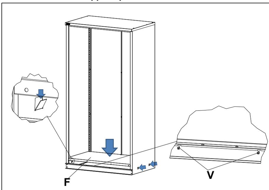
Завести днище **F** в отогнутые зацепы. Затем зафиксировать его на панели крепёжной при помощи саморезов **V** (5,5x16).
