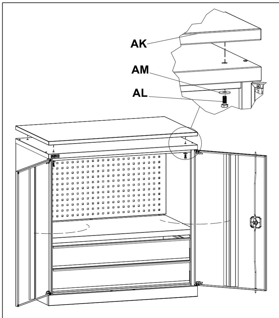
Установить столешницу **AK** на крышку шкафа ВЛ-051 при помощи болтов **AL** (M8x18) и шайб **AM**.
