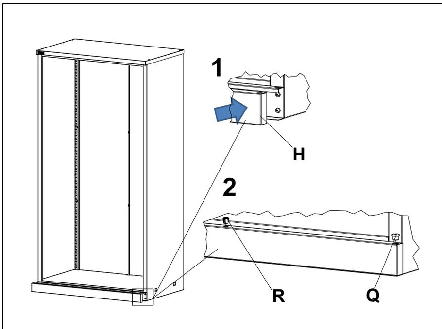
Установить панель нижнюю **H** на панель крепёжную, а затем установить на неё втулки **Q** и фиксаторы направляющей **R**.
