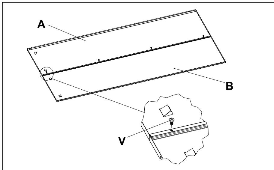
Соединить стенки задние **A**, **B** при помощи саморезов **V** (5,5x16).
