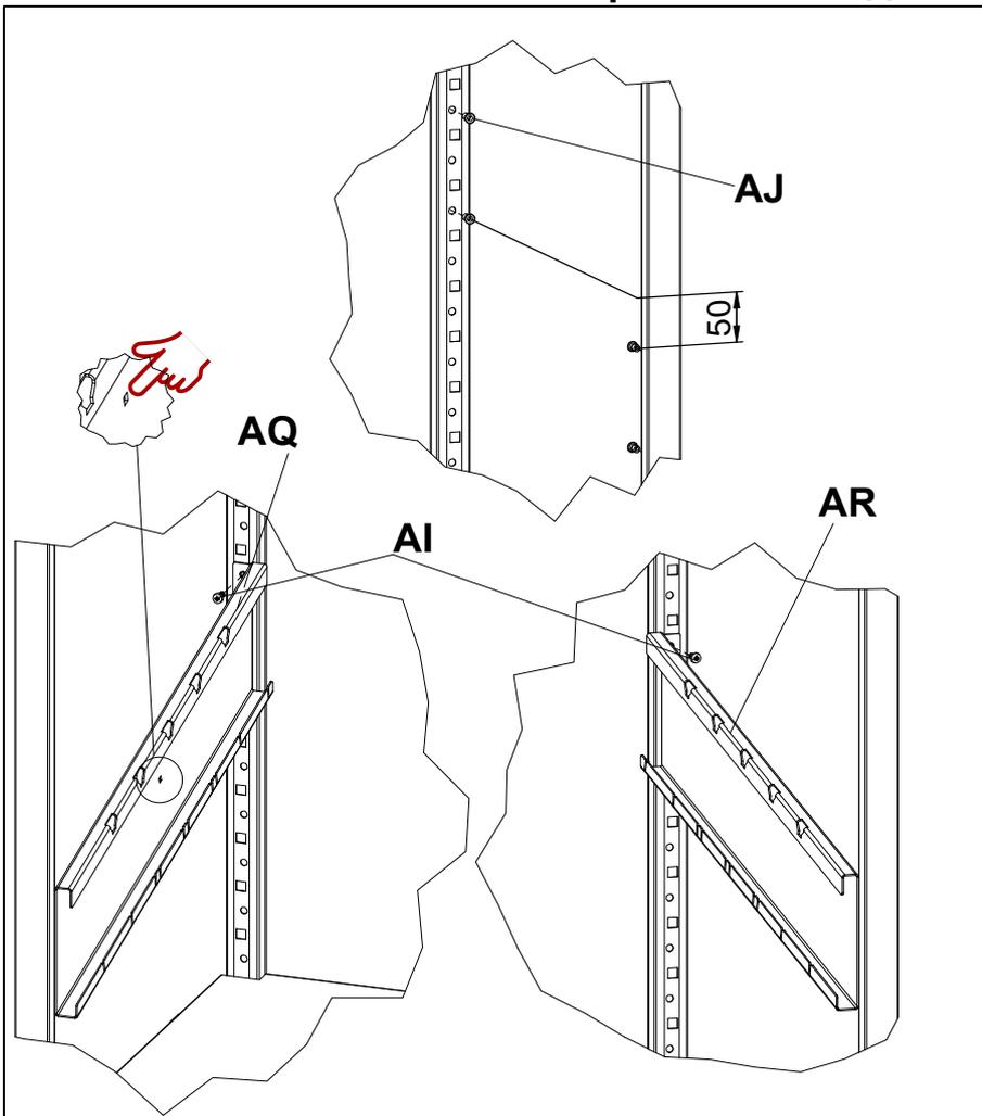
Завести заклёпки резьбовые **AJ** в отверстия боковин на нужной высоте, сместив верхнюю заклёпку в передней части шкафа на одно отверстие вниз относительно нижней заклёпки в задней части. Затем установить кронштейн левый **AQ** (отмечен □) и правый **AR** через заклёпки при помощи винтов **AI** (M5x12).
