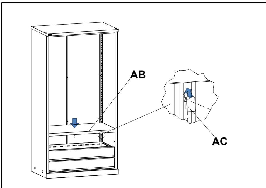
Завести опоры **AC** в круглые отверстия на боковинах. Установить полку **AB** на опоры.
