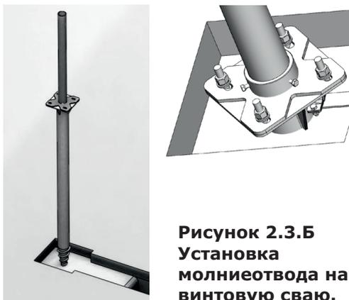
**Рисунок 2.3.Б Установка молниеотвода на винтовую сваю.**
