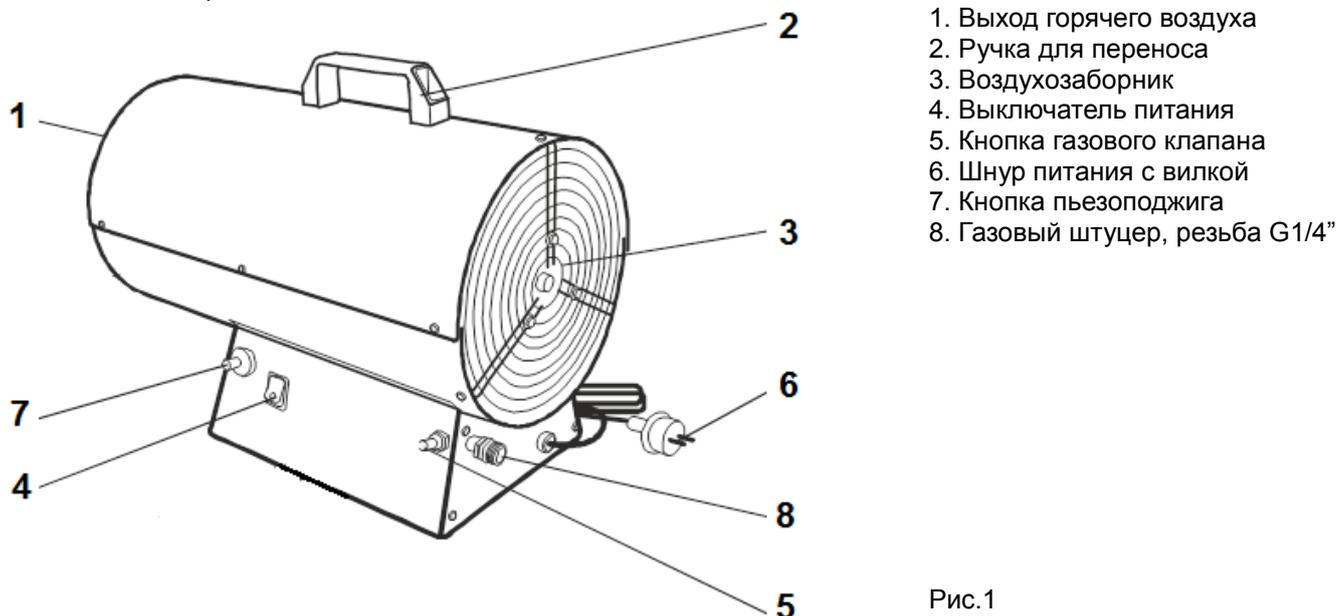
Конструктивно нагреватель состоит из цилиндрического внешнего корпуса, внутреннего корпуса, внутри которого установлен вентилятор с металлическими лопастями и газовая горелка. Между внутренним и внешним корпусом конструктивно предусмотрена воздушная прослойка для обеспечения теплоизоляции.
