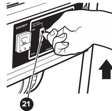
21. Автомат защиты от перегрузки (выключатель напряжения)
