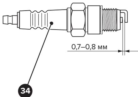
34. Свеча зажигания
