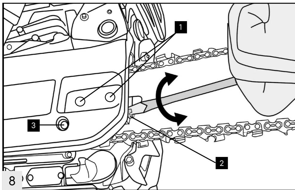
Цепь считается правильно натянутой, если ее можно передвигать по шине рукой с небольшим усилием. Цепь должна хорошо прилегать к нижней стороне полотна пилы и оттягиваться рукой от полотна приблизительно на 2–3 мм.
