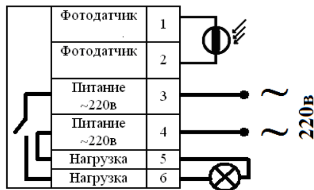
Рис. 4. Типовая схема подключения автомата к сети 220в.
