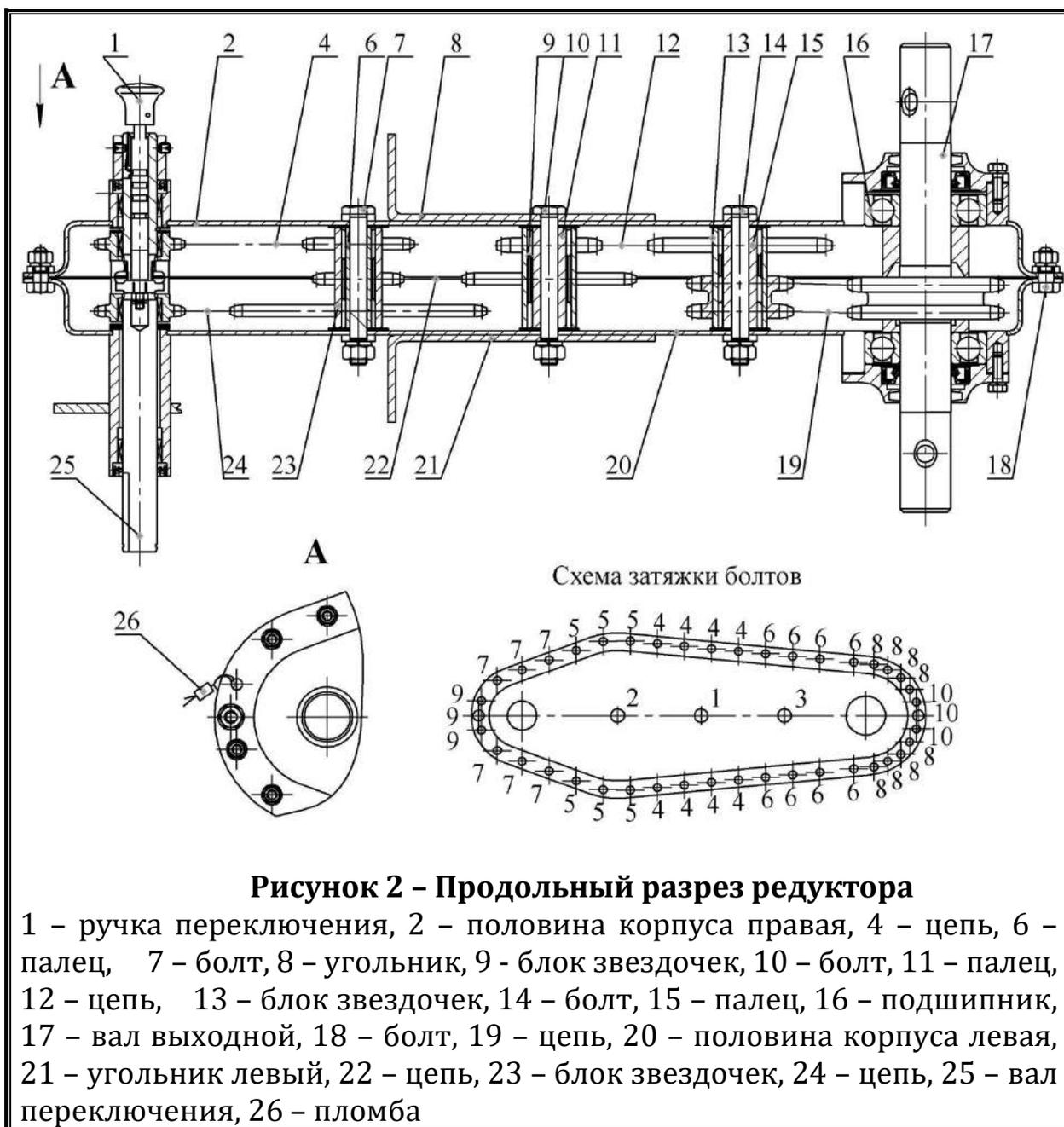
На внешние концы выходного вала 17 устанавливаются колеса (или культиваторы). На внешних концах вала имеются отверстия для фиксации колёс или культиваторов с помощью шплинтов или стопоров. К каждой из половин редуктора приварены угольники 8 и 21, к которым крепятся двигатель, руль, элементы клиноременной передачи.
