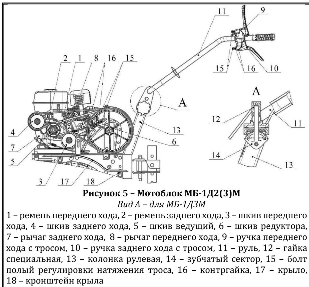
При нажатии ручки переднего хода 9 шкив переднего хода 3, перемещаясь с рычагом 8, создаёт необходимое натяжение ремня переднего хода 1 и вращение от ведущего шкива 5 через ремень переднего хода 1 передаётся на шкив редуктора 6.
