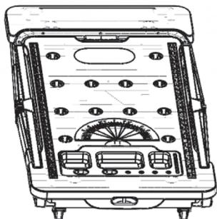
1. Найдите колеса, шайбы и винты в задней части верстака. Обратите внимание, что 2 поворотных колеса со стопором должны быть установлены под лотком для инструментов, а 2 оставшихся колеса должны быть установлены с другой стороны.
