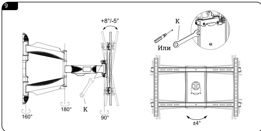
Регулировка углов наклона.
