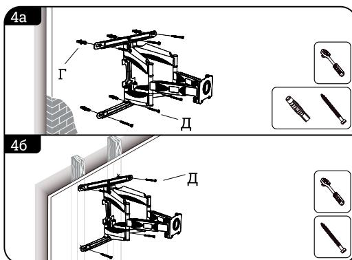
Установите 6 закладных под винты в просверленные отверстия, затем установите 6 винтов через отверстия крепления на настенной пластине.
