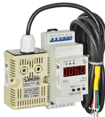
рования. В рабочем режиме индикатор отображает текущий уровень аммиака в воздухе. Зеленый светодиод индицирует наличие питающего напряжения, оранжевый — срабатывание реле 1 (1 канал), красный светодиод индицирует срабатывание реле 2 (2-й канал). Датчик входит в нормальный режим работы в течение 150 секунд после включения. В период до 3 минут исполнительные реле не срабатывают, но светодиоды каналов отображают то, как должны сработать реле по истечении этих 3 минут.
