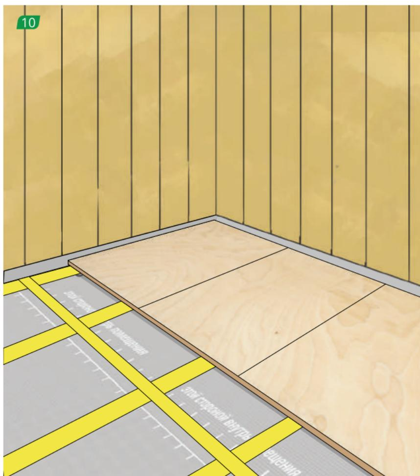
Монтируем плиты основания пола. Стыки плит основания пола должны располагаться на балках.
