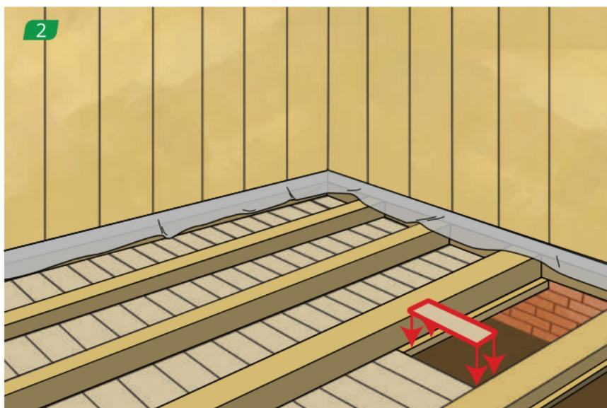
Поверх опорных брусков укладываем доски чернового пола и закрепляем их.
