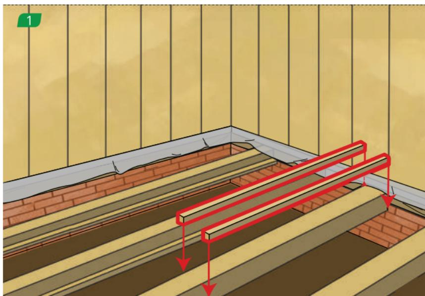
Монтируем опорные бруски чернового пола к балкам сбоку, с обеих сторон балки.
