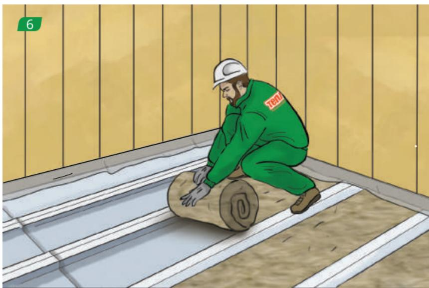
Укладываем утеплитель между балками. Теплоизоляция должна плотно прилегать к балкам. Не должно быть щелей и зазоров.
