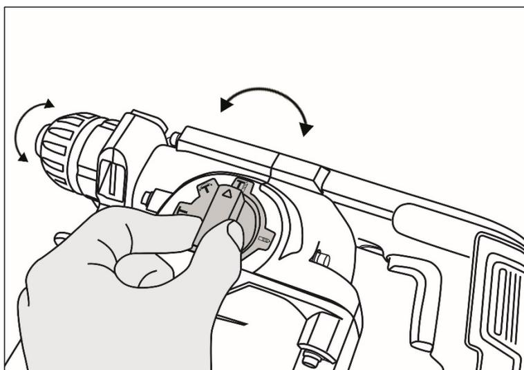
Рис. 16. Установка режима «Настройка углового положения инструмента»
