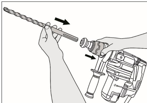
Рис. 8. Установка оснастки
