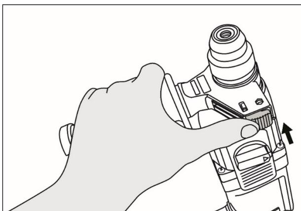
Рис. 5. Нажатие кнопки фиксации ограничителя глубины сверления
