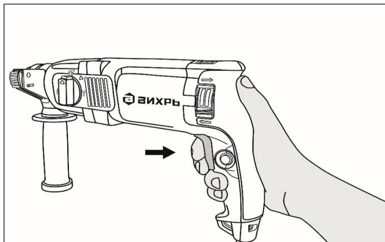
Рис. 13. Включение перфоратора
