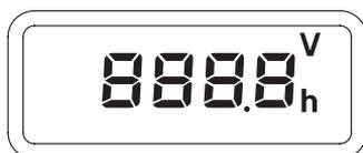
После отображения всех сегментов МИД попеременно показывает время работы электрогенераторной установки в часах и напряжение батареи в течение трех секунд.
