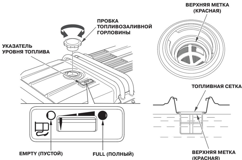
Заправку топливного бака следует производить при неработающем двигателе на открытом воздухе или в хорошо проветриваемых помещениях. Если двигатель перед этим работал, дайте ему остыть. Заправляйте топливный бак осторожно, чтобы избежать пролива бензина. Не заполняйте топливный бак выше верхней метки (красной) на топливной сетке.
