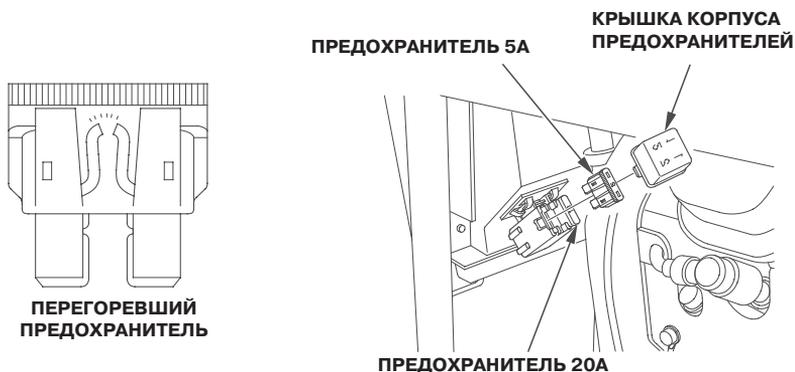
2. Снимите крышку корпуса предохранителей
