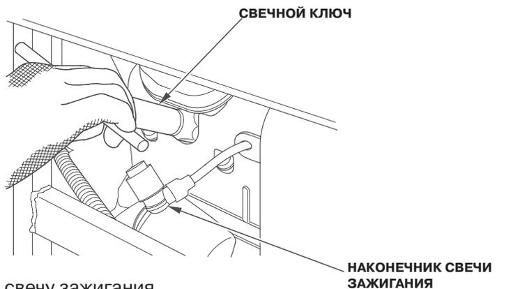
3. Осмотрите свечу зажигания. Замените свечу, если имеются следы износа на электродах или трещины, сколы или загрязнения на изоляторе.
