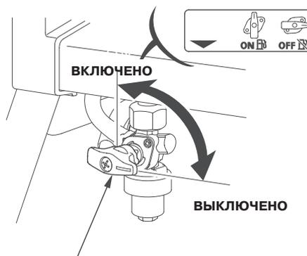
РУЧКА ТОПЛИВНОГО КРАНА
