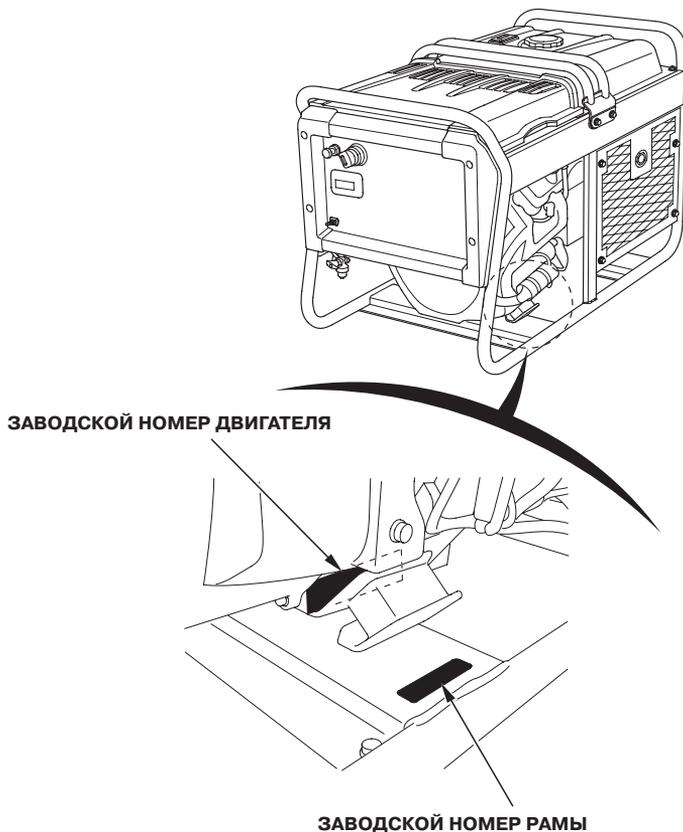
Запишите заводские номера двигателя и рамы в расположенные ниже строки. Вам потребуется указывать эти заводские номера при заказе запасных частей, а также при обращениях по техническим вопросам или в гарантийных случаях.
