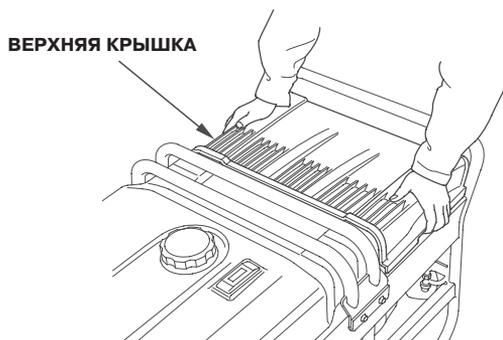
2. Отстегните четыре крепежные лапки от крышки воздушного фильтра и снимите крышку.
