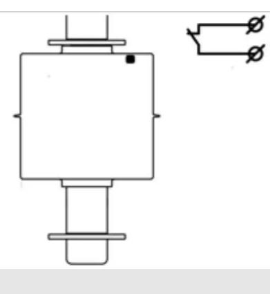
При расположении поплавка на зонде меткой вверх, в верхнем положении поплавка контакты реле замкнуты.
