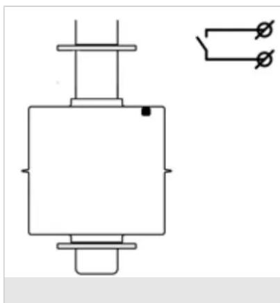
При расположении поплавка на зонде меткой вверх, в нижнем положении поплавка контакты реле разомкнуты.
