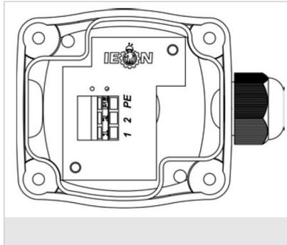
Контакты реле выведены на клеммы 1 и 2, клемма PE соединена с корпусом зонда.
