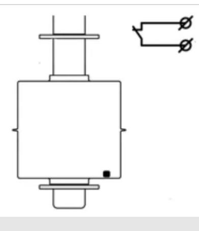
При расположении поплавка на зонде меткой вниз, в нижнем положении поплавка контакты реле замкнуты.
