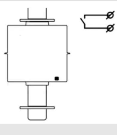
При расположении поплавка на зонде меткой вниз, в верхнем положении поплавка контакты реле разомкнуты.
