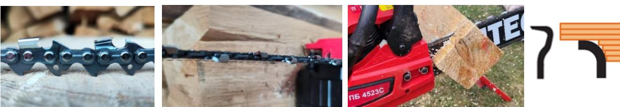
Для осуществления «узкого» реза требуется меньше энергии и крутящего момента. Пиление происходит быстрее, двигатель тратит меньше топливной смеси и инструмент, двигатель дольше работает на одной заправке топливного бака. Профиль режущих зубьев – “полу-долото” (semi-chisel) который имеет максимальную стойкость заточки к абразиву (грязь, песок, земля), который
