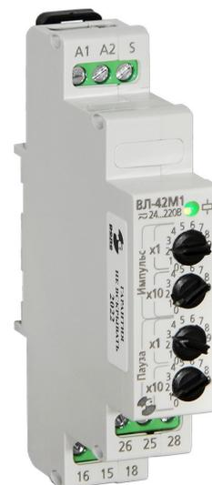
При подаче сигнала на управляющий вход отсчет времени для импульса или паузы может быть остановлен. Отсчитанное до этого момента время сохраняется. После снятия управляющего сигнала отсчет времени продолжается от сохраненного значения.
