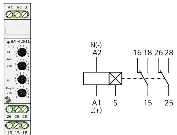
**ВНИМАНИЕ!** Для исключения сбоев в работе реле при коммутации индуктивной нагрузки (электромагнит, электромагнитный клапан и др.), подключите непосредственно к клеммам нагрузки помехоподавляющую цепь в виде последовательно соединенных резистора 100 — 200 Ом 2Вт и неполярного конденсатора 0.1 — 0.22 мкф 400 — 600В.
