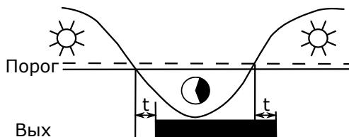
Диаграмма работы фотореле при установке порога и задержки срабатывания с помощью потенциометров на лицевой панели фотореле.
