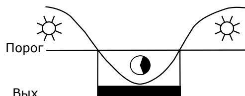
Диаграмма работы фотореле при установке порога срабатывания с помощью кнопки «порог» на лицевой панели фотореле.
