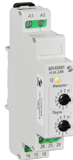
ключателя и двух регуляторов. С помощью нижнего регулятора и DIP-переключателей 5 — 8 устанавливается длительность паузы, с помощью верхнего регулятора и DIP-переключателей 1 — 4 устанавливается длительность импульса. Зеленый цвет свечения светодиода индицирует наличие напряжения питания на реле времени (отсчет времени паузы), красный цвет свечения светодиода индицирует срабатывание исполнительного реле (отсчет времени импульса).
