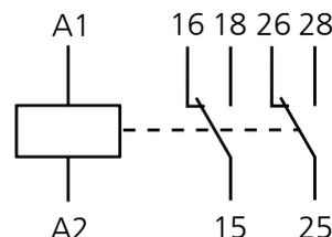
**ВНИМАНИЕ:** Для исключения сбоев в работе реле при коммутации индуктивной нагрузки (электромагнит, электромагнитный клапан и др.), подключите непосредственно к клеммам нагрузки помехоподавляющую цепь в виде последовательно соединенных резистора 100 — 200 Ом 2Вт и неполярного конденсатора 0.1 — 0.22 мкф 400 — 630В.
