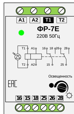
Рекомендуемая схема включения фотореле при мощности нагрузки до 300Вт (исключая лампы ДРЛ)
