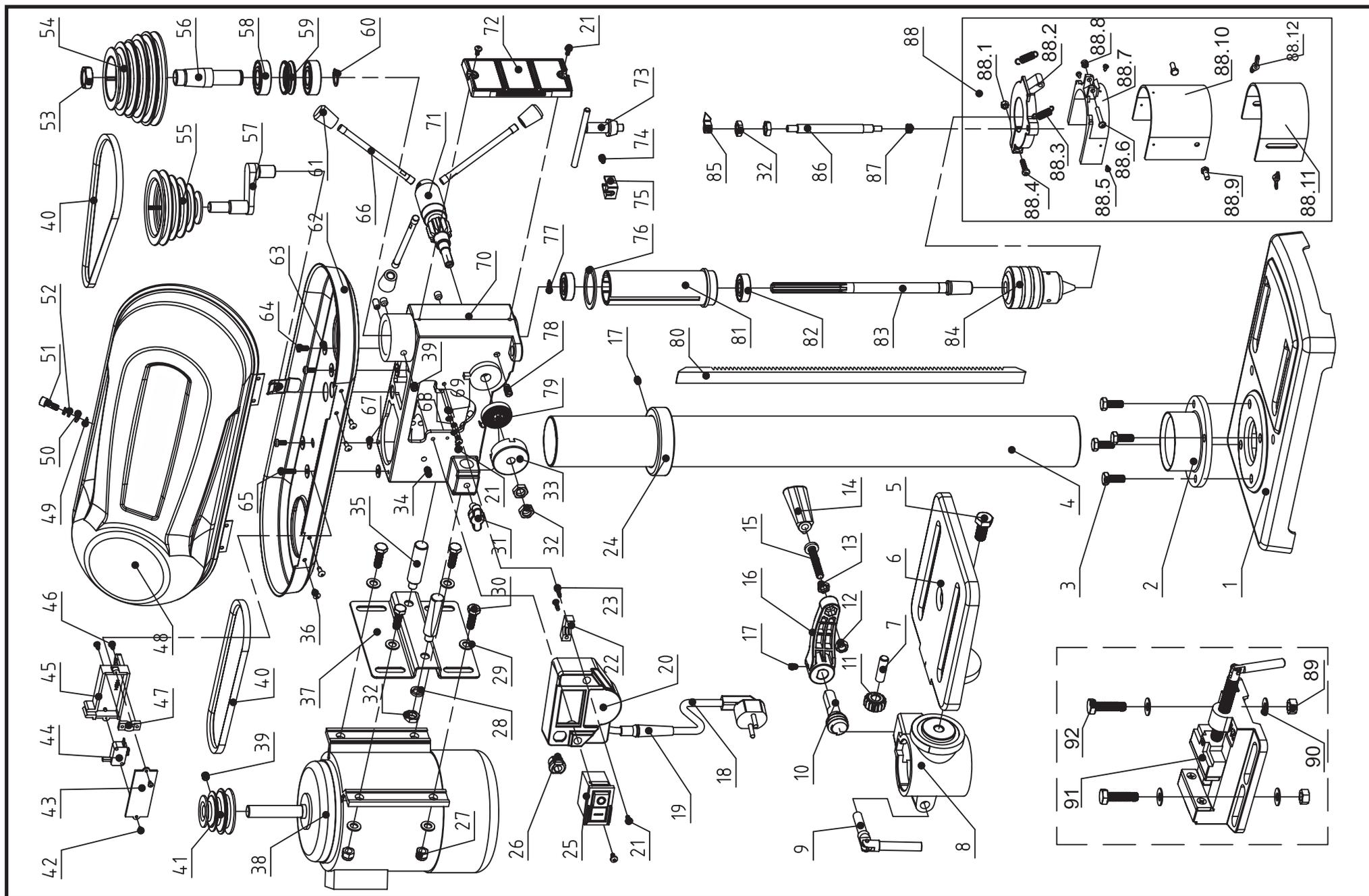
Станок сверлильный DM-16/630. Схема сборки, лист 2 - листов 2
