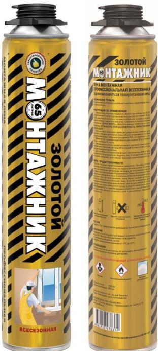
**Золотой Монтажник** – профессиональная универсальная однокомпонентная полиуретановая пена, предназначенная для работы в диапазоне температур от -16°C до +35°C. Выход пены – до 60 литров. Наилучшие результаты достигаются при применении пены при температуре не ниже -12°C.
