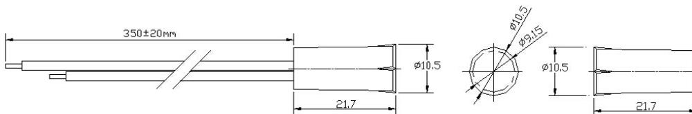
Извещатель магнитоконтактный ST-DM015NO-BR предназначен для контроля положения различных строительных конструкций (дверей, окон, люков, ворот и т.д.). Данное устройство может использоваться в системах охранной сигнализации или контроля и управления доступом.
