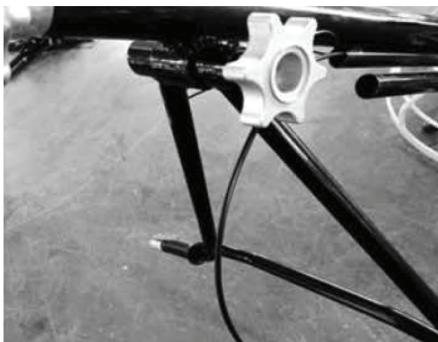
5. Вставьте соединительную часть в правильное положение на двигателе. Вставьте в соединительную часть кабель датчика масла от двигателя и кабель выключателя останова двигателя от рукоятки управления.
