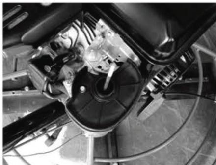
7. Пластиковой стяжкой закрепите кабель выключателя останова двигателя и тросик регулятора подачи топлива в нужном положении.
