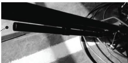
4. Открутите болты на рукоятке управления, подсоедините ее к трубе рукоятки и закрутите болты.
