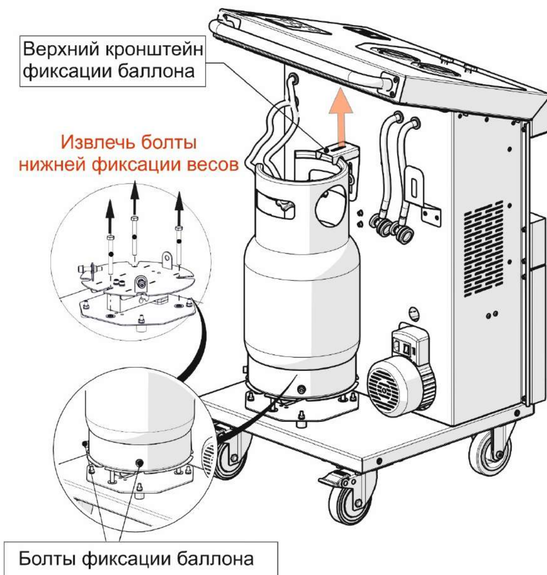
Рис. 5 Фиксация внутреннего бака
