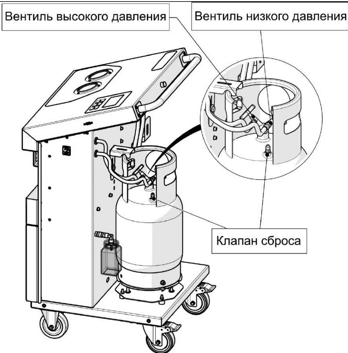
Рис. 7 Сброс неконденсируемых газов.
