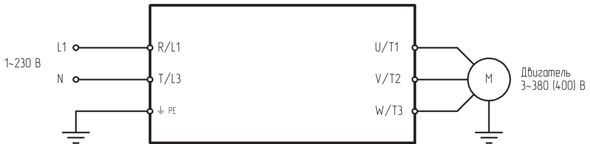
Подключение силовых клемм для моделей LCI-GY/PY-3
