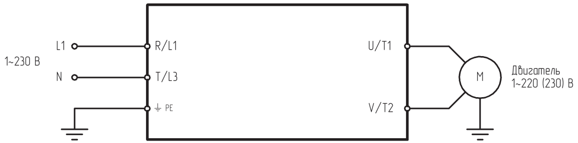
Подключение силовых клемм для моделей LCI-GY/PY-1
