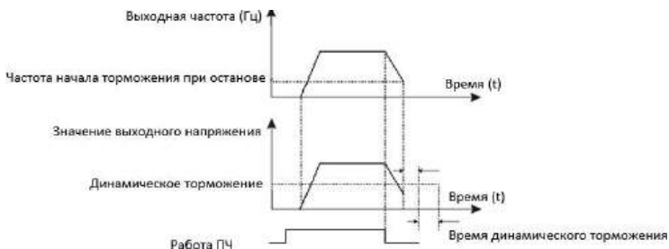
Рис. 6.4 Процесс торможения постоянным током
