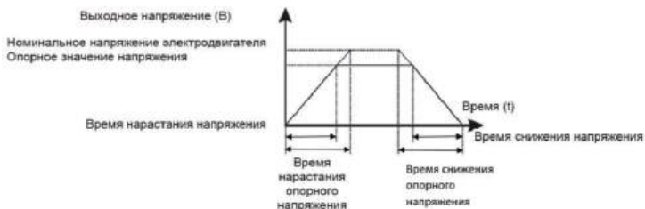
Рис.6.8 Время нарастания и снижения напряжения
