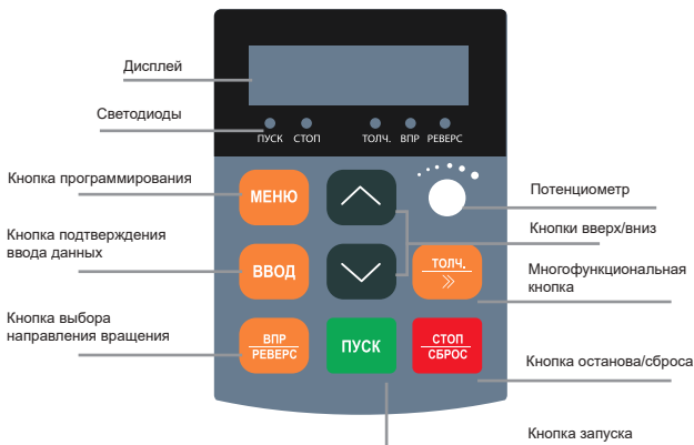
Рис. 5.2 Функции кнопок и светодиодов панели управления LCI(S)
