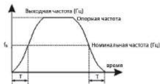
Рис. 6-3 Кривая S разгона/торможения B
