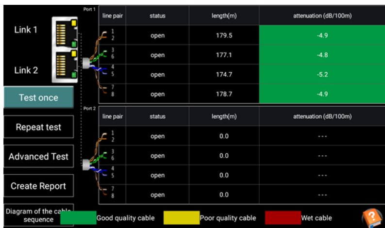
Рис. 125 Интерфейс рефлектометра (TDR) для кабеля «витой пары»
