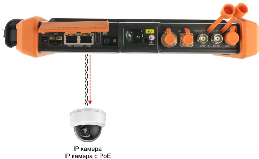
Рис. 7 Подключение IP-видеокамеры к тестеру
