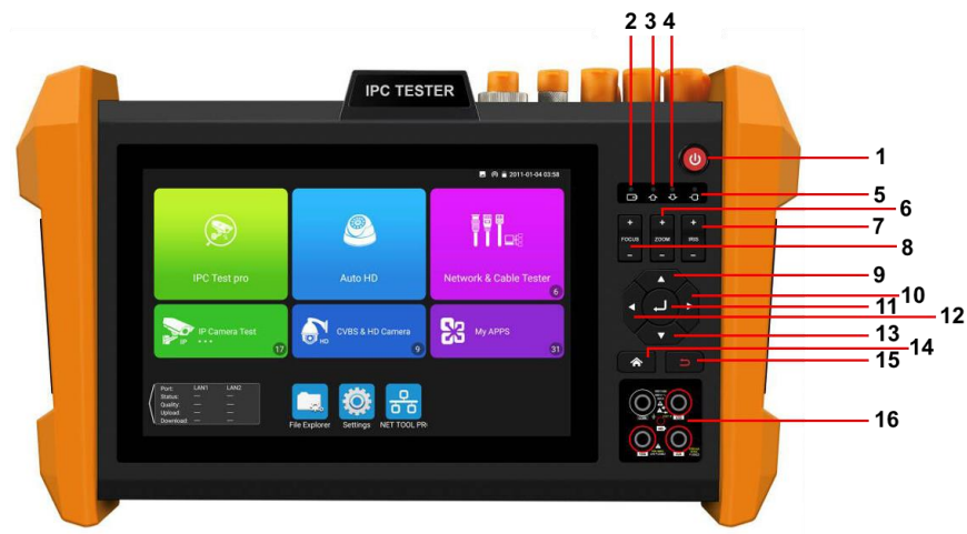
Рис. 4 Тестер TIP2-HOL-MTRC-7, разъемы, кнопки и индикаторы на передней панели
