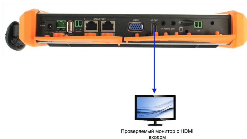
Рис. 18 Подключение тестера к HDMI-монитору в режиме генератора сигнала
