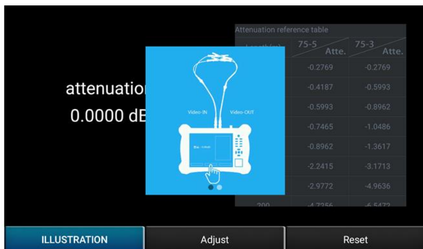
Рис. 131 Подключение кабеля для определения степени затухания
