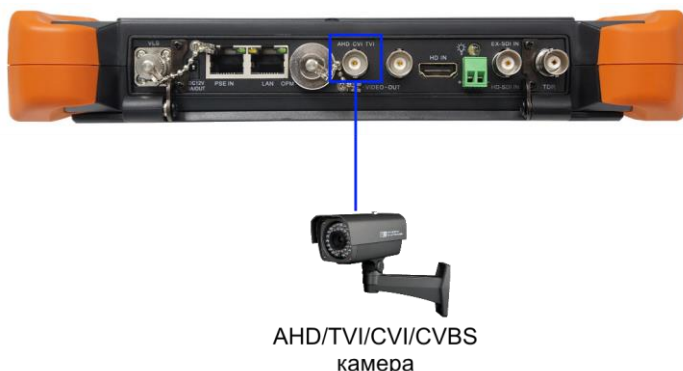
Рис. 13 Подключение AHD/TVI/CVI/CVBS видеокамеры к тестеру
