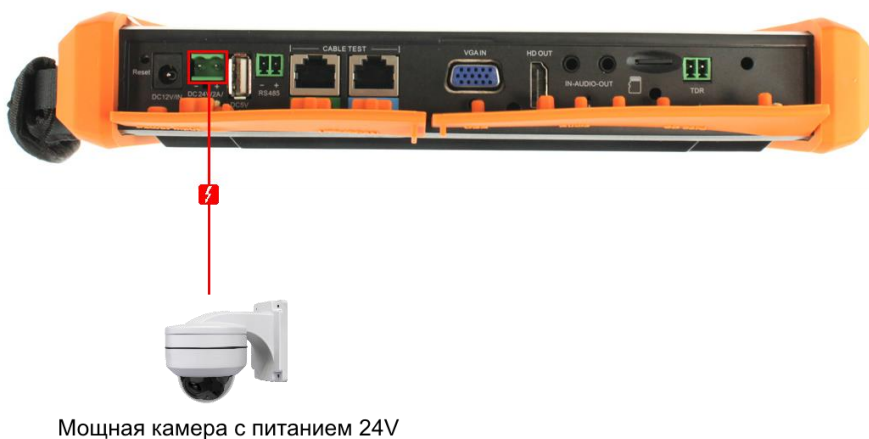
Рис. 10 Подключение питания к мощной IP-видеокамере без PoE
