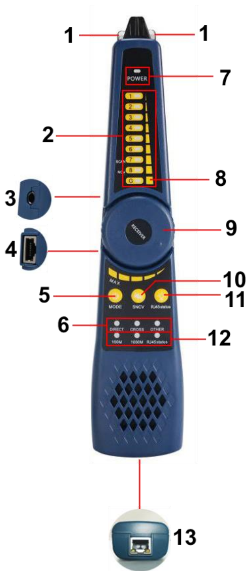
Рис. 122 Мультифункциональный щуп, разъемы и индикаторы
