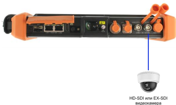
Рис. 15 Подключение EX SDI / HD SDI видеокамеры к тестеру
