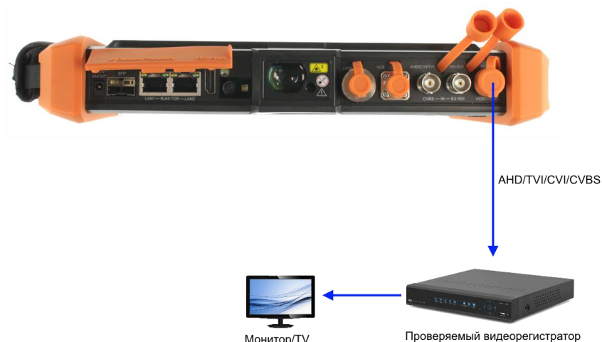
Рис. 16 Подключение тестера к проверяемому устройству в режиме генератора видеосигнала
