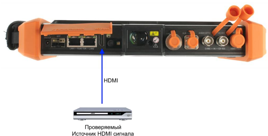
Рис. 17 Подключение HDMI устройств к тестеру.
