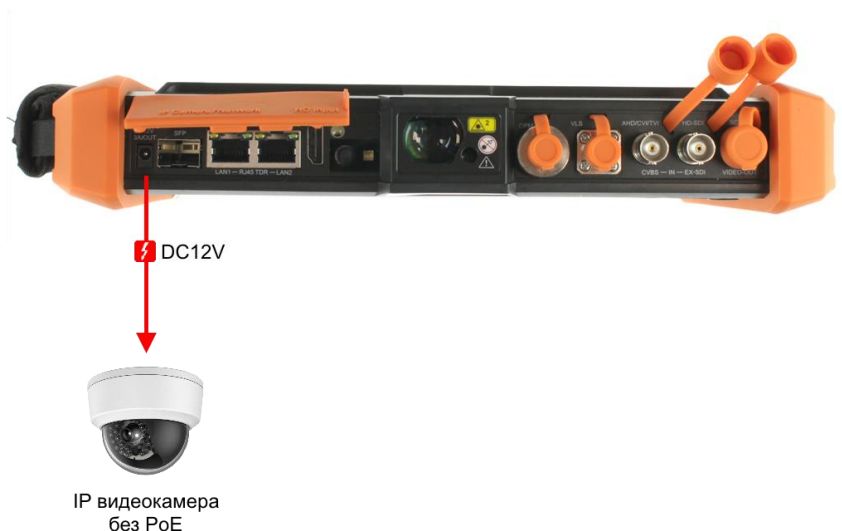
Рис. 9 Подключение питания к IP-видеокамере без PoE
