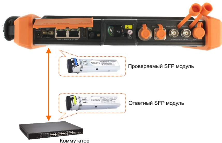
Рис. 191 Подключение SFP модуля для проверки.
