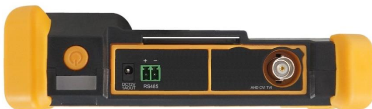
Рис. 2 Тестер TSH-H-4,3, внешний вид сверху
