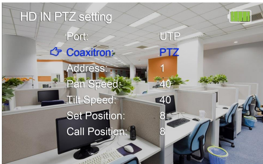
Рис.13 Меню настроек PTZ видеокамеры (режим управления по коаксиальному кабелю)
